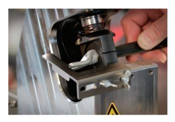
Der TS1300 ist ein Tischständer, der mit den Pressköpfen DV1300C2 und V1300C2-AL verwendet werden kann. Der tischständer ist für Bediener konzipiert, die den C2-Presskopf mit hoher Frequenz verwenden. Mit dem Tischständer erhalten Sie eine stabile, sichere und einfache Verwendung des C2-Presskopfs.
