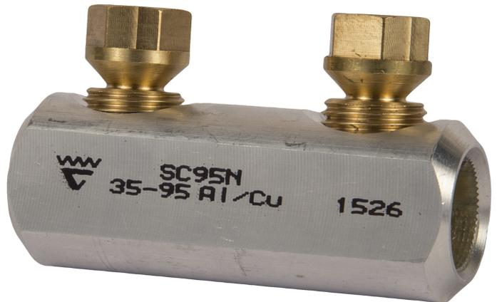
Schraubverbinder 1 kV, passend für Al- und Cu-Leiter der Klasse 1 und 2. Rundleiter 35-95 mm<sup>2</sup>, Sektorleiter 50-95 mm<sup>2</sup>. Beim Verbinden von Schirmleitern mit 6-35 mm<sup>2</sup> kommt die Einlage SC95N/PEN zum Verbinden der Kupferabschirmung des Kabels zum Einsatz.
