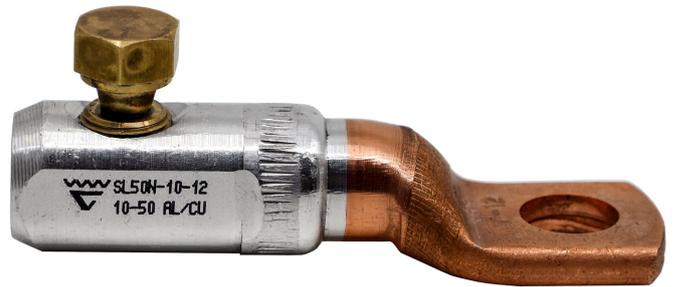
Schraubkabelschuh 1 kV, passend für Al- und Cu-Leiter der Klasse 1 und 2. Rundleiter 10-50 mm<sup>2</sup>, Sektorleiter 10-50 mm<sup>2</sup>. Passend für M10 und M12, Reduzier- und Unterlegscheibe sind im Lieferumfang enthalten.
