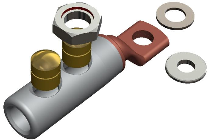
Schraubkabelschuh 1-36 kV, passend für Al- und Cu-Leiter der Klasse 1 und 2. Rundleiter 95-150 mm<sup>2</sup>, Sektorleiter 95 mm<sup>2</sup>. Passend für M10 und M12, Reduzier- und Unterlegscheibe sind im Lieferumfang enthalten.
