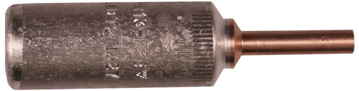
AlCu-Stoßverbinder von mehrdrähtigem Al-Leiter mit 95 mm<sup>2</sup> oder massivem Al-Leiter mit 120 mm<sup>2</sup> auf massiven Cu-Leiter mit 10 mm<sup>2</sup>. Beim Sechskant-Crimpen des Cu-Leiters werden die Pressbacken zwischen Markierungsnut und Außenkante positioniert. Verwendung mit den zertifizierten Elpress-Systemen V1300 oder V250.
