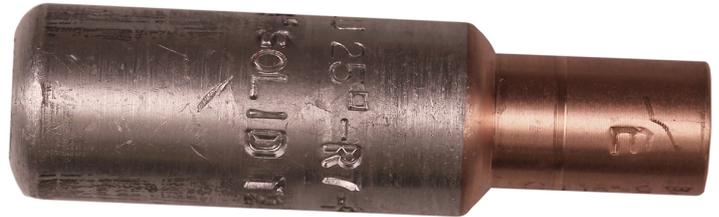
AlCu-Stoßverbinder, zum Verbinden eines Al-Leiters mit einem Cu-Leiter. Für mehrdrähtigen Al-Leiter mit 25 mm<sup>2</sup> oder massiven Al-Leiter mit 35 mm<sup>2</sup> auf mehr- oder feindrähtigen Cu-Leiter mit 16 mm<sup>2</sup>. Beim Crimpen des Cu-Teils werden die Pressbacken zwischen der Markierung an der Hülse und der Außenkante positioniert. Verwendung mit den zertifizierten Elpress-Systemen V1300 oder V250.
