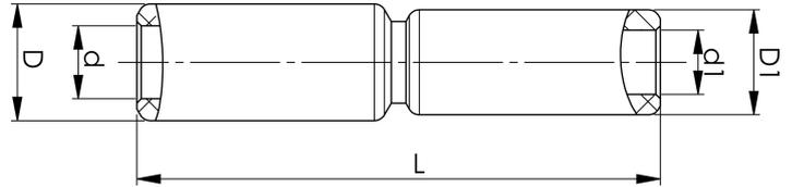
Al-Stoßverbinder mit Zwischenwand für mehrdräftige Al-Leiter mit 25-16 mm<sup>2</sup> oder für massive Al-Leiter mit 35-25 mm<sup>2</sup>. Zum Verbinden von Al-Leitern mit unterschiedlichen Querschnitten. Verwendung mit den zertifizierten Elpress-Systemen V1300 oder V250.
