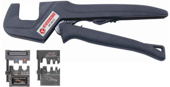
Mechanisches Crimpwerkzeug mit Wechselbacken. Zwei Wechselbacken enthalten: OAA0525 zum Crimpen isolierter Verbinder mit 0,5-2,5 mm<sup>2</sup> und OEB0210 zum Crimpen von Aderendhülsen mit 0,25-10 mm<sup>2</sup>.
