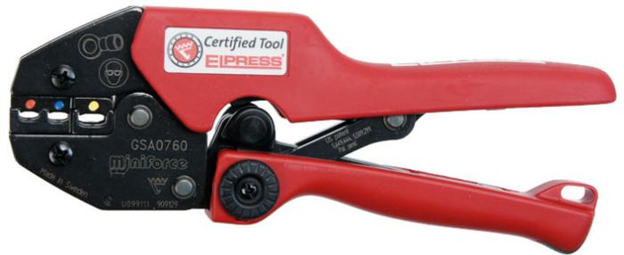
Geprüfte und zertifizierte mechanische Miniforce-Handzange zum symmetrischen Crimpen isolierter Verbinder mit 0,5-6 mm<sup>2</sup>.
