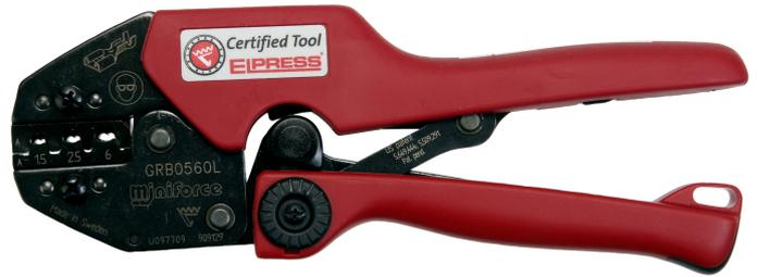
Geprüfte und zertifizierte mechanische Miniforce-Handzange zum Roll-Crimpen unisolierter Verbinder mit 0,5-6 mm<sup>2</sup>. Werkzeug vom Typ L mit drei austauschbaren Locator-Ausführungen für verschiedene Kabelschuhe.
