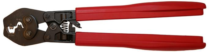
Geprüfte und zertifizierte mechanische Handzange zum Dorn-Crimpen von Cu mit 10-16 mm<sup>2</sup>, Al mit 16-25 mm<sup>2</sup> und Al mit 16-25 mm<sup>2</sup>.
