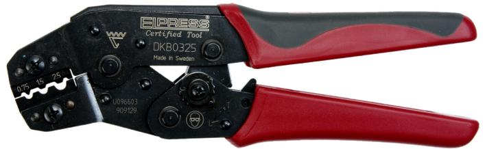
Geprüfte und zertifizierte mechanische Handzange zum Dorn-Crimpen von Cu-Verbindern mit 0,25-2,5 mm<sup>2</sup>.
