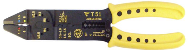
Hobbyzange zum Crimpen isolierter Verbinder mit 0,5-6 mm<sup>2</sup> und Roll-Crimpen unisolierter Verbinder mit 0,5-2,5 mm<sup>2</sup>. Gelber Griff.
